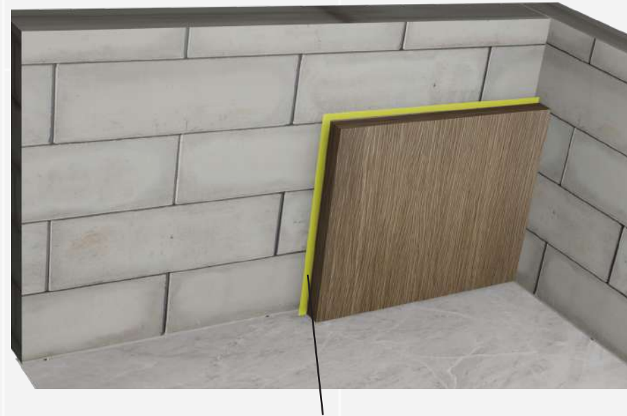
Расстояние между панелями 1-10 мм
